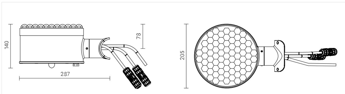
Nella versione standard del prodotto, le lunghezze dei cavi sono le seguenti: cavo di alimentazione 5m; cavo segnale per pulsante pedonale 5m; cavo di alimentazione lampada 2,5m. Le lunghezze standard consentono il montaggio del sistema sul palo SAL DL -10.
