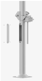
2. Rimozione del coperchio della cavità del palo
